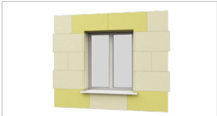
Colocación correcta de los paneles próximos a las aberturas
