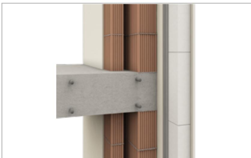
Estratigrafía de estructura aislada con Mapetherm System
