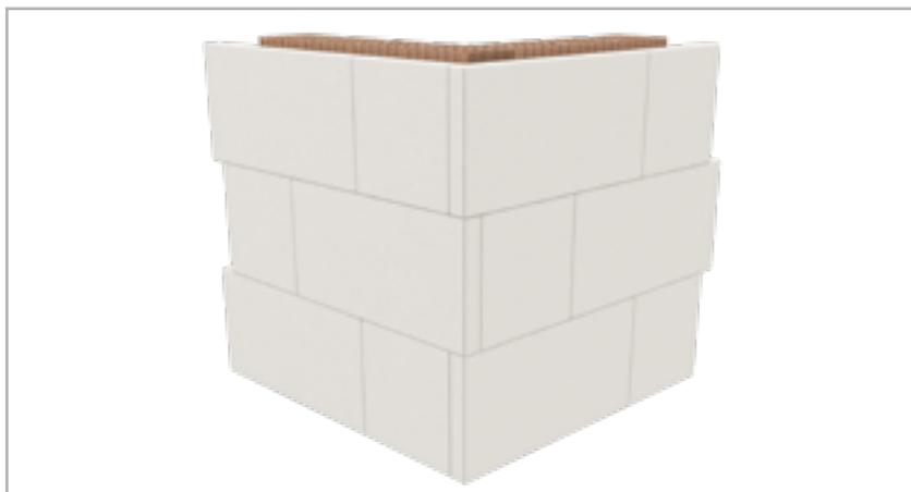
Con el fin de beneficiarse al máximo del poder de adhesión es necesario proceder a la colocación del panel, especialmente en épocas calurosas y ventosas, inmediatamente después de la aplicación del adhesivo sobre el reverso del aislante.
