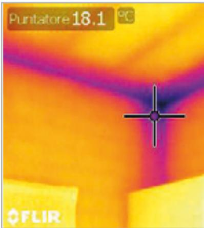
El mismo ambiente visto con cámara térmica de infrarrojos: en correspondencia de los puentes térmicos corregidos con Mapetherm System se observa una temperatura de 18,1°C
